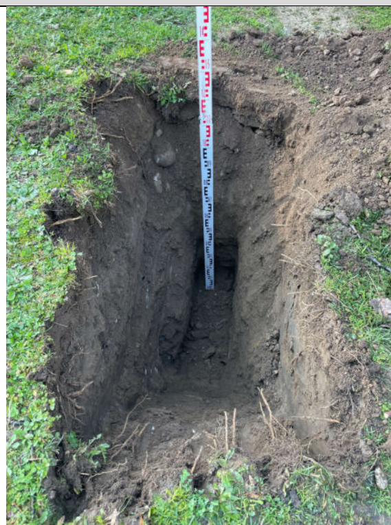
Ripresa fotografica durante esecuzione scavo esplorativo (a sx) e stratigrafia scavo (a dx)
